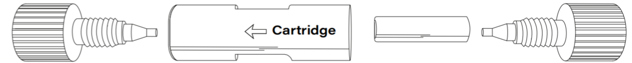
Figure 9: 捕集柱柱套 (型号 FSH.01)、捕集柱柱套 (型号 FSH.05) 及 1/32 英寸螺纹接头
